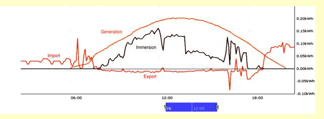
I den anden graf vandet har nået denne temperatur med 12,30 da der er mindre brugt vand. For resten af den dag termostaten cykler til at holde vandet varmt. Trods skyerne går forbi, hvilket gør den generation variabel op til 12,30 for I2 hurtige processor meget præcist styrer eksport til en stabil minimum og udøver derved hver gang termostaten skærer i igen. Den har kun importerer strøm, når solen er for svagt til at forsyne hele huset belastning og eksport, når vandet er varmt.
